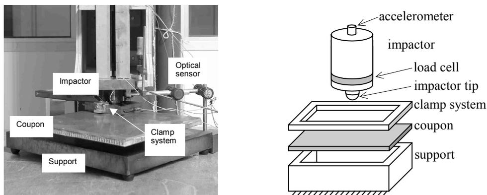
Figure 1 : Impact apparatus
