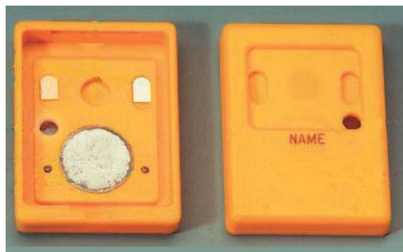
Abb. 4.2. Gleitschattendosimeter, geöffnet
