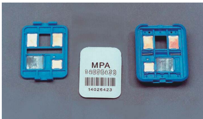
Abb. 4.1. Filmdosimeter, geöffnet
