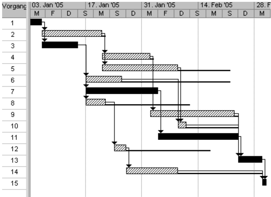
Abb. 6-2: Diagramm der PLANNET-Technik
