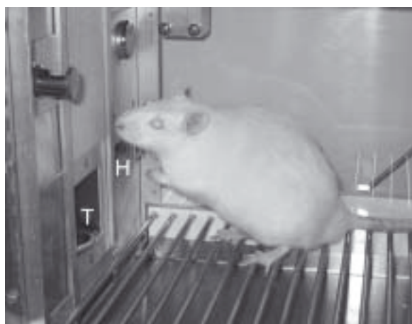
■ Abb. 9.2. Operante Konditionierung im Reinstatement-Modell. Wistar-Ratte beim Hebeldruck in einer operanten Kammer (Skinner-Box). Während der Konditionierungsphase erhält das Versuchstier bei jeder Betätigung des Hebels (H) eine festgelegte Menge 10%ige Alkohollösung als Belohnung ( positive reinforcement ), die über einen Tropf-Dispenser (T) angeboten wird. Alkoholabhängige Tiere drücken in Einzelfällen bis über 400-mal während einer halben Stunde
