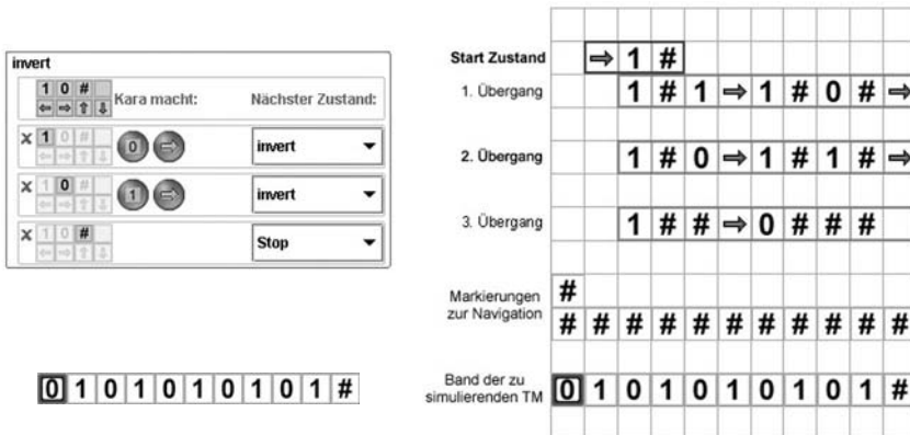
Abb. 6.12. Kodierung des Bitstring-Invertierers für die TuringKara-UTM
