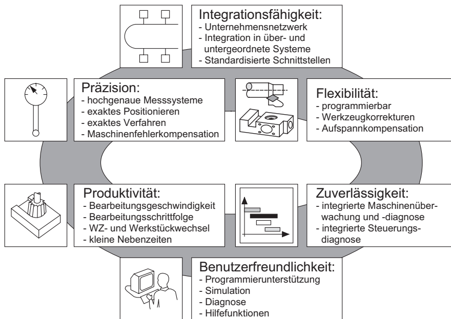
Bild 6.1. Anforderungen an die numerische Steuerung innerhalb der Werkzeugmaschine (nach [63])
