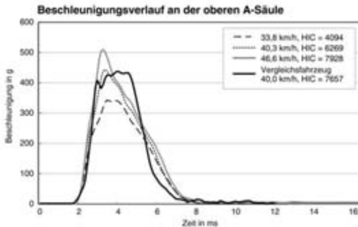
Abb. 4.38 Errechnete Beschleunigungsverläufe beim numerisch durchgeführten Komponententest an der A-Säule und der Vergleich mit einem Realversuch am Beispielfahrzeug F ( m_{\text{Impaktor}}=4,8\text{kg} ).
