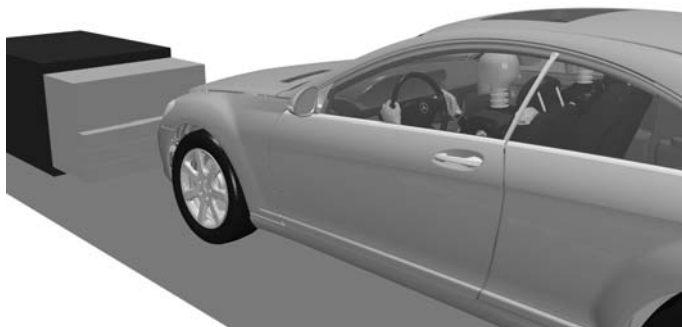
Abb. 9.22. Konfiguration ODB-Crash (Quelle: Daimler-Chrysler AG).
