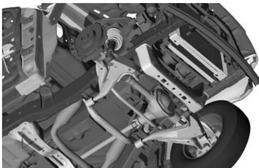
Abb. 9.3. Crashmodell; einige Teile des Modells sind ausgeblendet (PAMCRASH-Beispielmodell).
