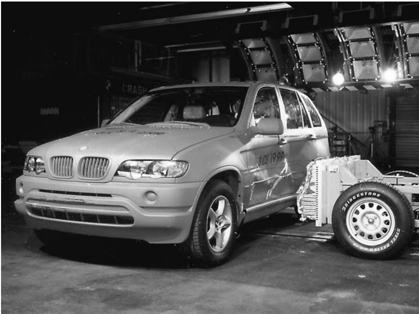
Abb. 9.24. Seitencrash eines BMW X5 (Quelle: BMW).
