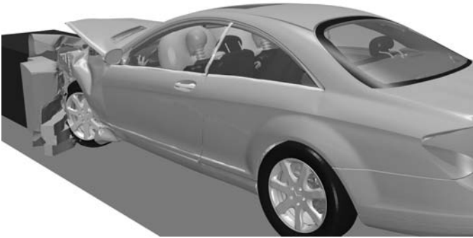
Abb. 9.23. Simulationsergebnis für einen ODB-Frontalcrash (Quelle: Daimler-Chrysler AG).
