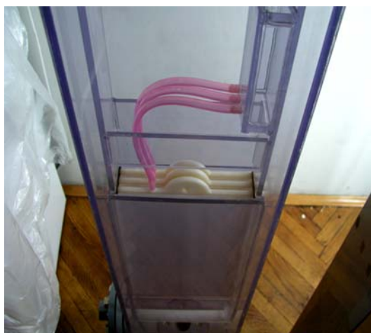
Fig. 7 Plate-and-frame immersed membrane module (Kubota, Japan)
