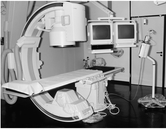
Abb. 2.5. Philips-DSA-Anlage „Integris V3000“ (Philips Medizin Systeme)
