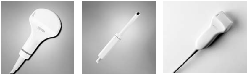
Abb. 18.41. Kommerzielle Ultraschallköpfe für unterschiedliche medizinische Untersuchungen
