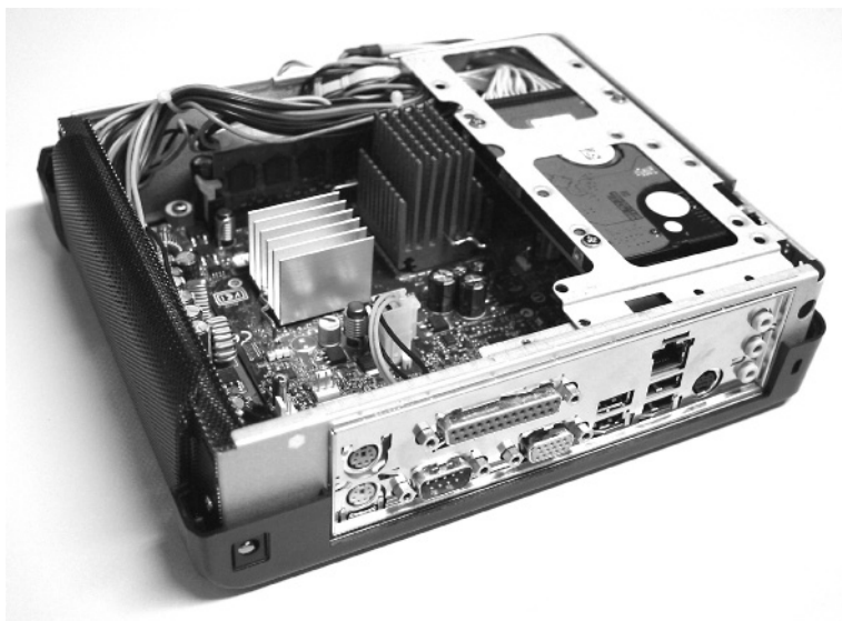
Abb. 2.8. Rechner auf Basis eines Mini-ITX-Mainboard D945GCLF2 von Intel mit Dual-Core Intel Atom 330 Prozessor.
