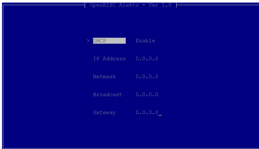
Figure 9: BIOS: Configure Network Parameter
