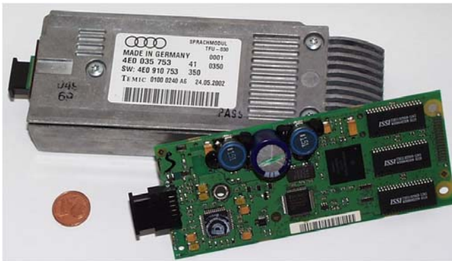
Abbildung 3.4. Hardwaremodul eines SDS aus dem Audi A8
