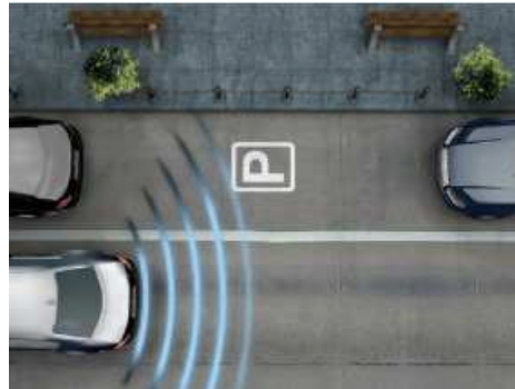
Bild 3: Es befindet sich kein Hindernis im hinteren Nabereich des Fahrzeugs. Die Ultraschallsignale werden nicht zurückgeworfen. Es ertönt kein Warnsignal.
