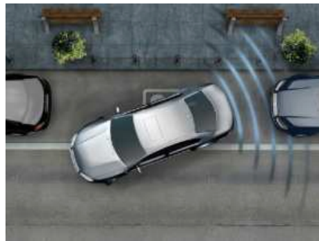
Bild4: Die Ultraschallsignale werden von einem Hindernis zurückgeworfen. Es ertönt ein Warnsignal.
