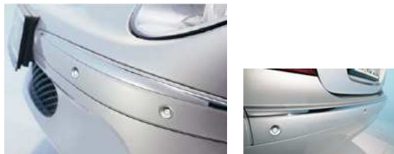
Bild 2: Ultraschall-Sender bzw. -Empfänger im Stoßfänger (links: vorne; rechts: hinten)
