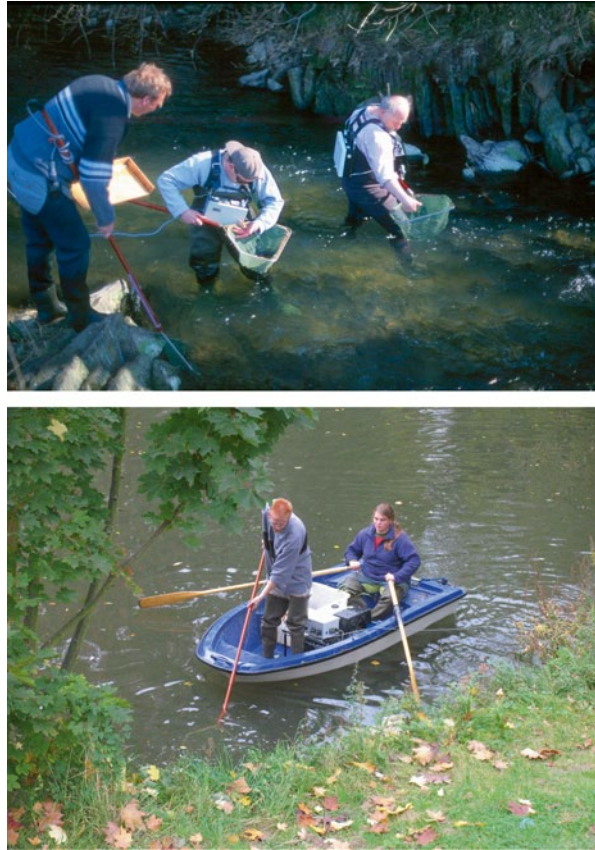
Abb. 6.3 Elektrobefischungen mit batteriebetriebenen, tragbaren Fanggeräten sind in bewatbaren Fließgewässern bis etwa 1 m Tiefe möglich ( oben ). Die Elektrobefischung tieferer Gewässer erfolgt hingegen vom Boot aus mit leistungsstärkeren Generatorgeräten ( unten )
