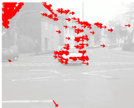
Abbildung 3.24: Optischer Fluss, wie er sich bei einer Autofahrt darstellt. An die Bildpunkte, von denen der Fluss berechnet werden konnte, wurde ein Pfeil gezeichnet, der die Bewegungsrichtung zwischen zwei Bildern angibt. Die Kamera bewegt sich in der Szene nach links. Die dargestellten Autos bewegen sich nach vorne rechts.
