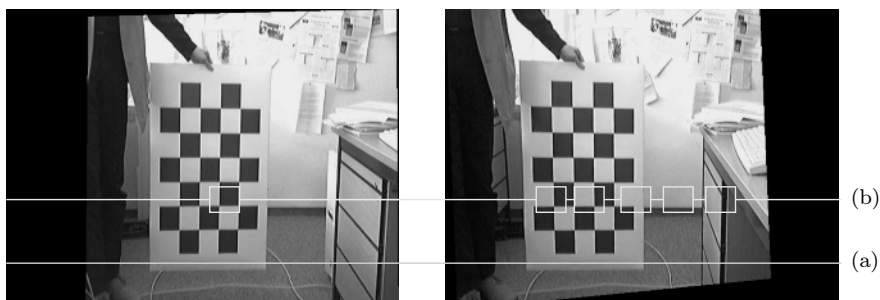
Abbildung 3.22: Rektifizierte Stereobilder erlauben es, korrespondierende Punkte entlang einer horizontalen Linie zu finden. Da viele Pixelwerte auf der Linie (a) gleich sind, verwendet man einen Ausschnittsvergleich (b).
