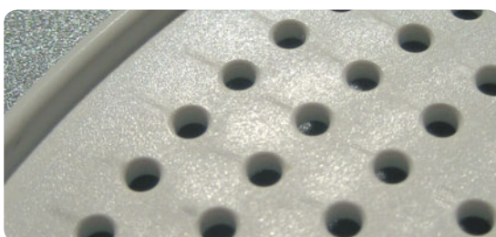
Bild: Unschöne Bindenähte im sichtbaren Bereich der Bauteiloberfläche, Anguss ist hier im Bild unten rechts.
