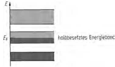
Bild 16-7. Energiebänderschema eines elektrischen Leiters (Metall)
