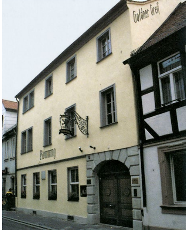
Abb. 2.26 Erlangen, Apfelstr.2. Barockes Wohn- und Geschäftshaus aus dem Jahre 1699 mit verputzten Backsteinwänden und Sandsteinquaden am Tor im Erdgeschoss, verputztes Fachwerk in den Obergeschossen
