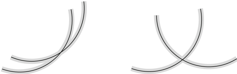
Abb. 1.2. Ein kleiner Schnittwinkel links (Genauigkeitsverlust) und ein großer Schnittwinkel rechts.
