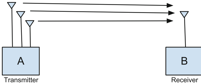
Fig. 2.7 A 3 \times 1 MIMO link
