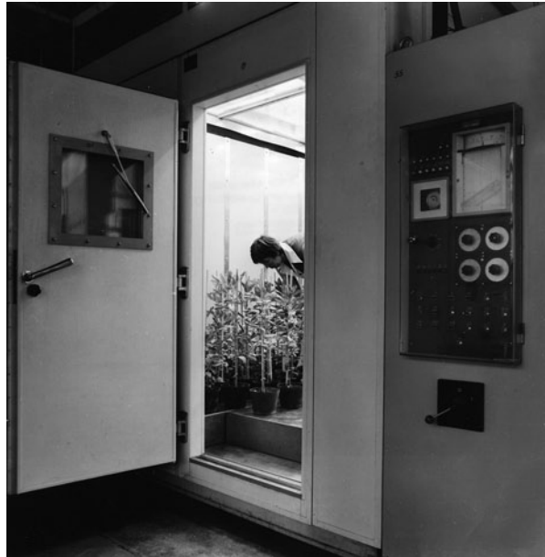
Abb. 2.29 Blick durch die geöffnete Tür in eine der begehbaren Pflanzenwuchskammern (Phytotrone) der Firma VEB NEMA Netzschkau aus der DDR, worin die Gartenmeisterin Annemarie Silhengst mit Ackerbohnen ( Vicia faba ) arbeitet (1980er-Jahre)
