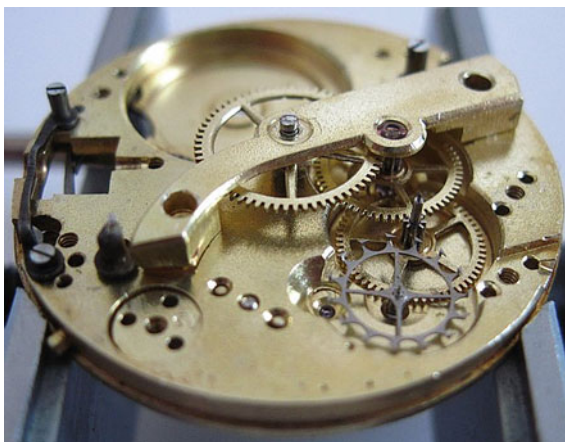
Fig. 2.28 Zylinderwerk 2 using cylinder escapement
