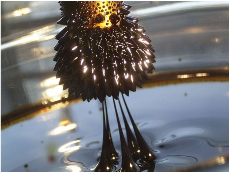
Abb. 5.7 Magnetorheologische Flüssigkeit (Bildrechte: M.-D. Weitze)
