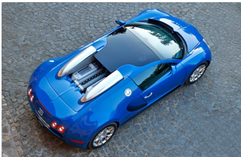
Abb. 5.5 Das Panoramadach eines Bugatti Veyron ist aus Polycarbonat gefertigt. Die gut ein Quadratmeter große Fläche wiegt 5,6 Kilogramm. Glas wäre doppelt so schwer. (Bildrechte: Bugatti)
