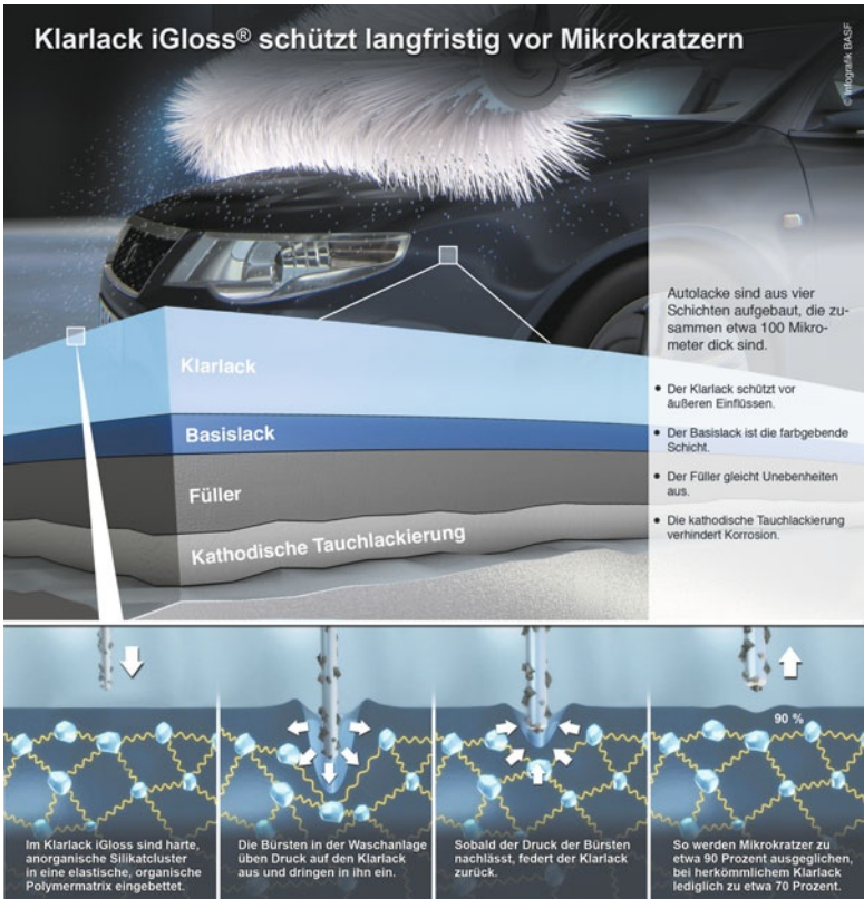
Abb. 5.6 Autolack besteht aus vier Schichten, von denen die oberste für Glanz und Kratzfestigkeit entscheidend ist. (Bildrechte: BASF SE)
