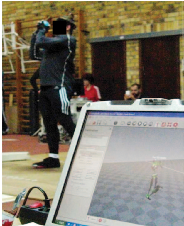
Abb. 5.27 Bewegung des Kugelstoßers und gleichzeitige Verfolgung des Modells des Ganzkörperinertialmesssystems am Monitor. (Quelle: Ganter et al. 2011)
