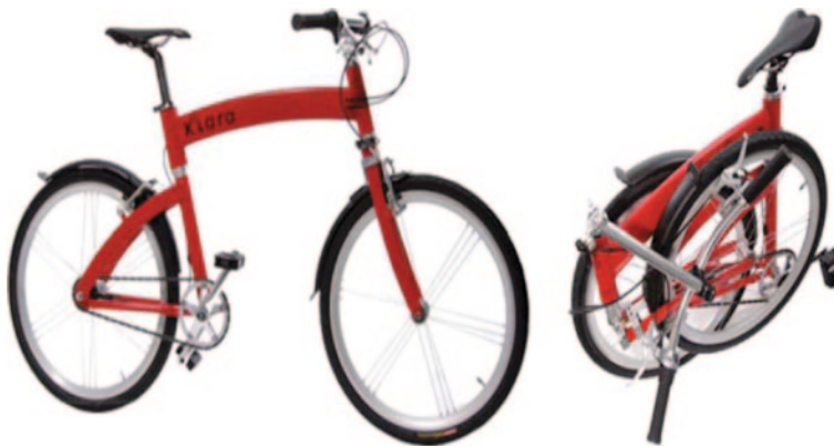
Abb. 5.6 Funktionsfähiger Prototyp des Klappfahrrades (entsprechend dem Lösungskonzept 3). (Quelle: Müller 2004; in Ponn und Lindemann 2011)
