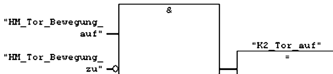
Abb. 10.10 FUP der Torsteuerung (Teil 1)
