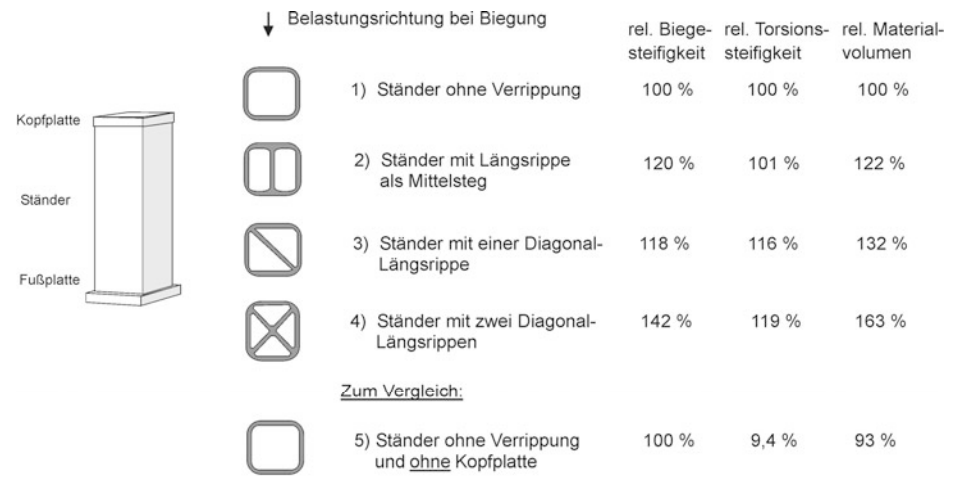
Abb. 2.79 Relative Biege- und Torsionssteifigkeit sowie das relative Materialvolumen, bezogen auf den Ständer ohne Verrippung (100 %), bei Ständern mit verschiedenen Längsverrippungen. (Quelle: nach Untersuchungen des WZL [Werkzeugmaschinenlabor] der Rheinisch-Westfälischen Technischen Hochschule [RWTH] Aachen).
