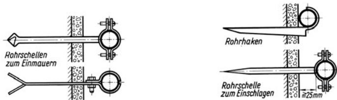
2.58 Befestigung von Stahlrohren und anderen Leitungen am Mauerwerk
