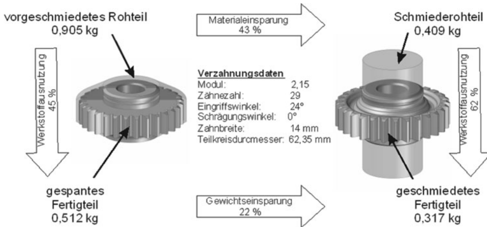
Abb. 2.1 Zahnradrohling geschmiedet aus dem Vollen gefräst [Lao97]
