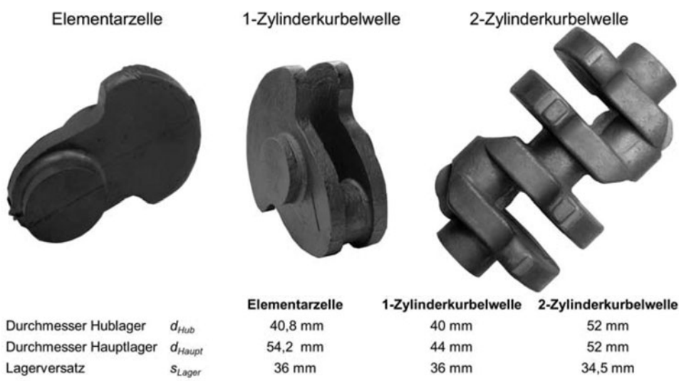
Abb. 2.4 Elementarzelle, 1- und 2-Zylinderkurbelwelle
