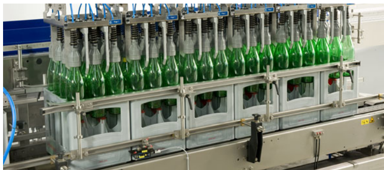
Abb. 2.19 Kastenstrom mit Leergut am Auspacker Linattec II [1.24]
