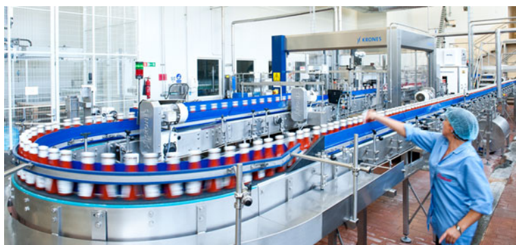
Abb. 2.20 Flaschenstrom nach der Etikettiermaschine Solomatic [1.24]
