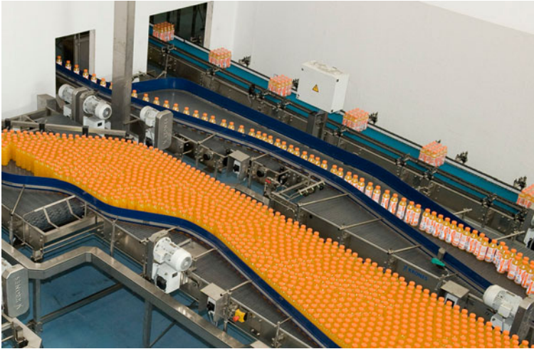
Abb. 2.21 Speicherstrom, Einzelflaschenstrom, Gebindestrom [1.24]
