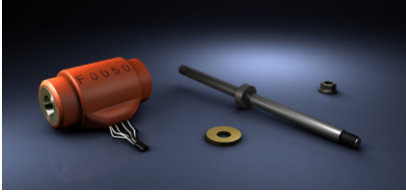
Bild 2.12: Auf ein Signal hin brechender Verschluss (»Frangibolt«). Ein Zylinder aus einer Formgedächtnislegierung wird durch Stromzufuhr erwärmt und kann eine Schraube an einer Kerbe brechen lassen. Solche Verschlüsse werden beispielsweise in der Raumfahrt eingesetzt, um Teile abzusprengen oder Solarsegel auszufalten. (Mit freundlicher Genehmigung der TiNi Aerospace, Inc.)
