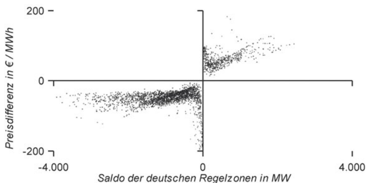
Abbildung 2.5: Preis für Regelleistung und Regelzonensaldo für alle Viertelstunden des Monats März 2011 im Vergleich. 25
