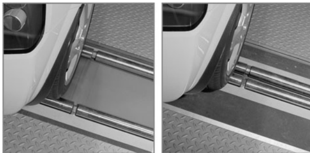
Abb. 2-64 Zentriervorrichtung geöffnet (links), geschlossen (rechts)
