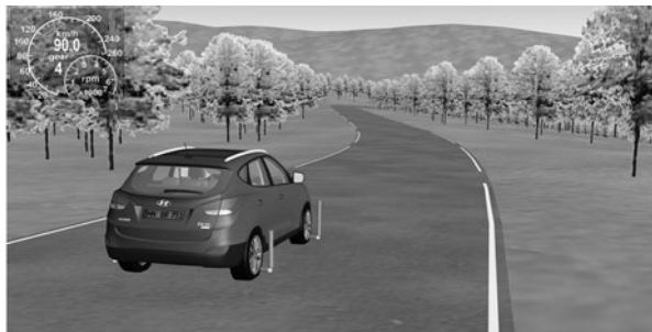
Abb. 2-13 Manöverbasiertes Testen am Motorprüfstand
