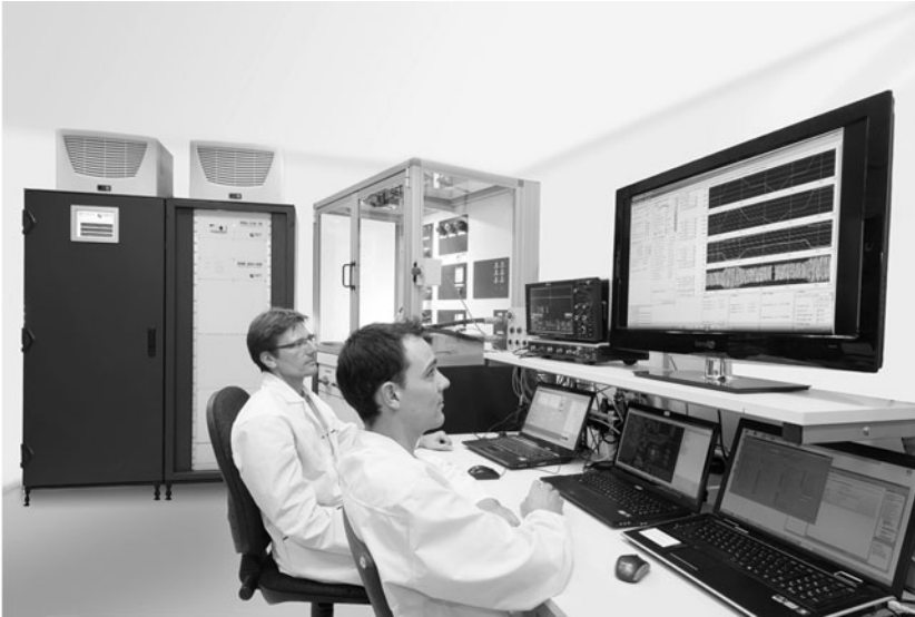
Abb. 2-38 Typischer Inverterprüfstand für den Hochvoltantriebsstrang
