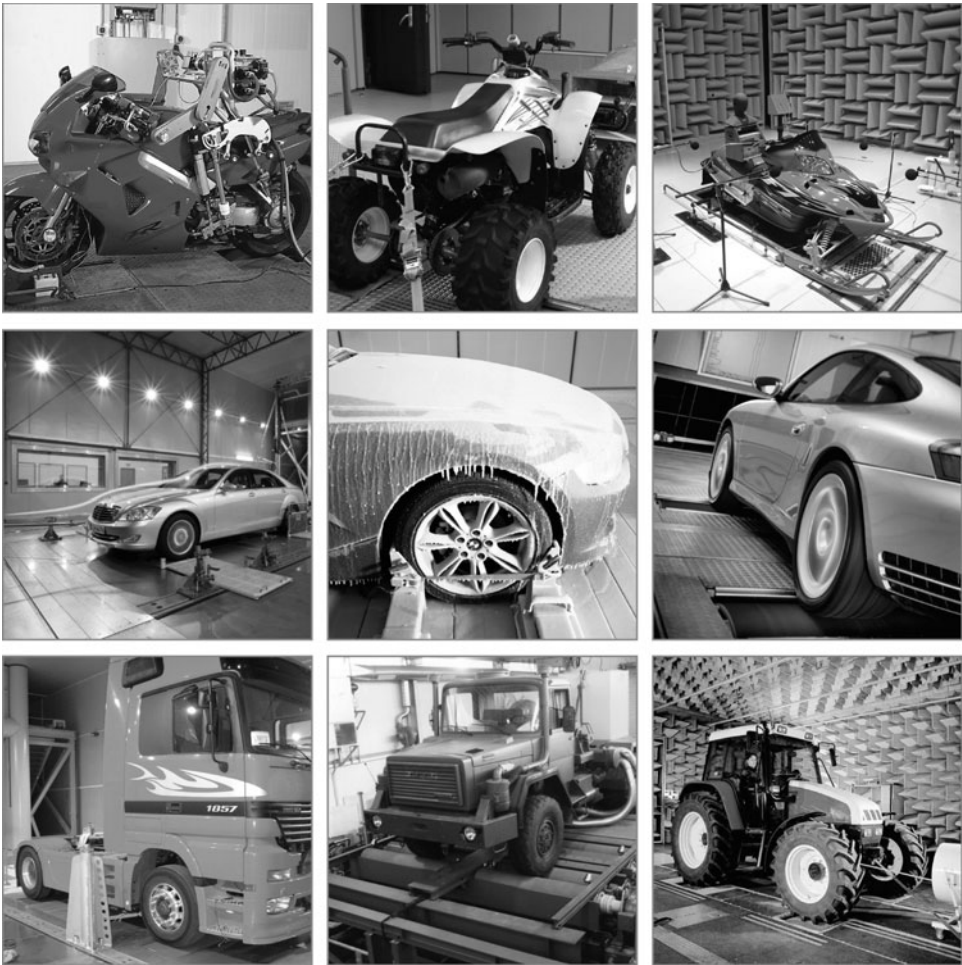
Abb. 2-62 Fahrzeugspektrum auf Rollenprüfständen
