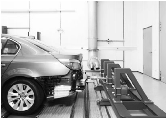
Abb. 2-75 Spezielles Fesselungskonzept zur Bestimmung der Längsbeschleunigung
