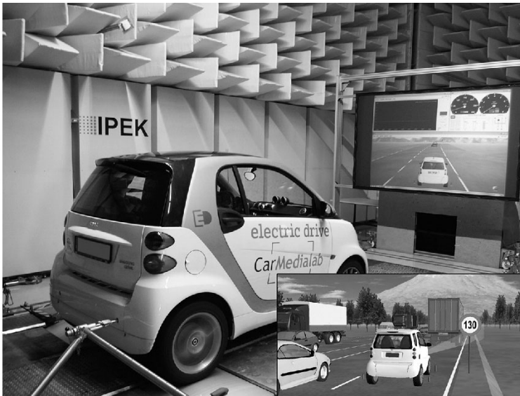
Abb. 2-76 Vehicle-in-the-Loop am Rollenprüfstand (Quelle: IPEK – Institut für Produktentwicklung am KIT)
