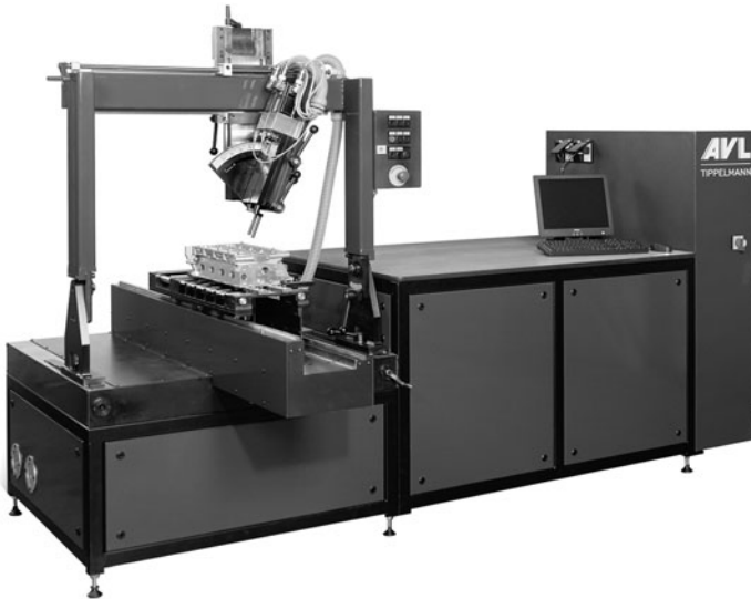
Abb. 2-18 Vorentwicklungsprüfstand für die Strömung einzelner Zylinderköpfe
