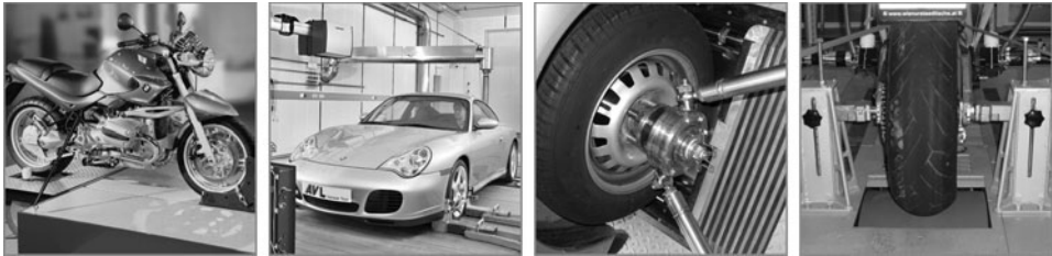
Abb. 2-63 Fesselungskonzepte an Fahrzeugrollenprüfständen
