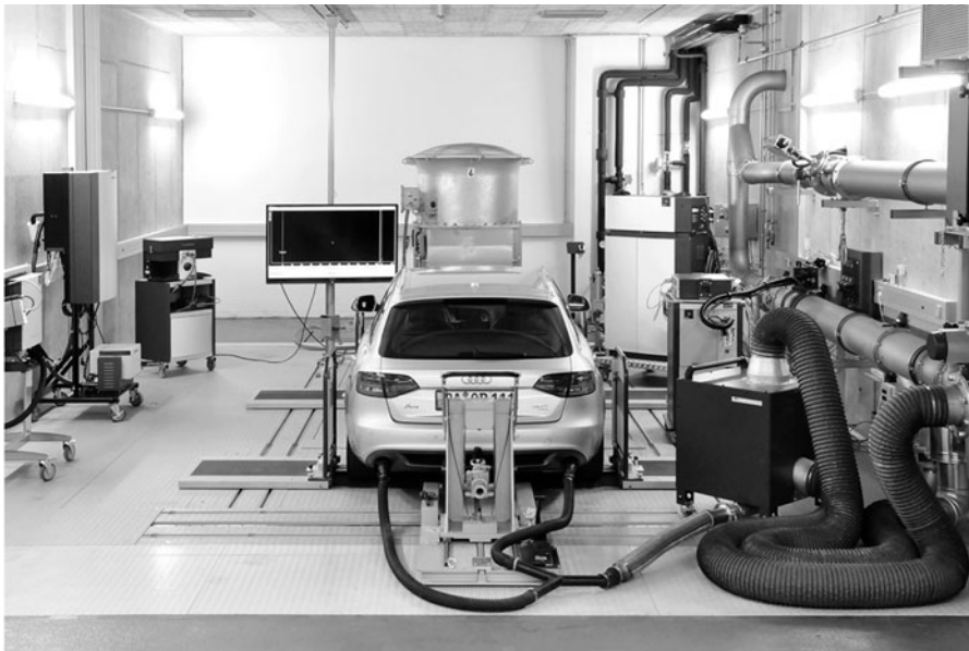
Abb. 2-67 Moderner 4x4-Rollenprüfstand mit Schwerpunkt auf Abgasemissionszertifizierung (Quelle: TÜV Hessen Automotive)
