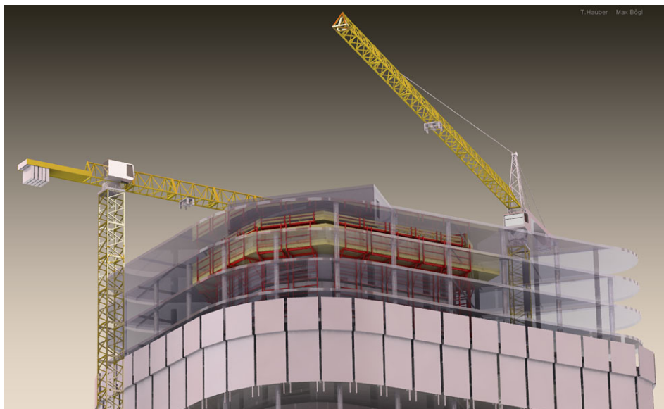
Abb. 2.2 Lokale 3D Simulation für das Zusammenspiel der beiden Krane in Bauprozessen beim Hochhaus, z. B. beim Versetzen der Absturzsicherung
