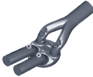
21 Typisches Strömungsvolumen für die CFD-Berechnung
