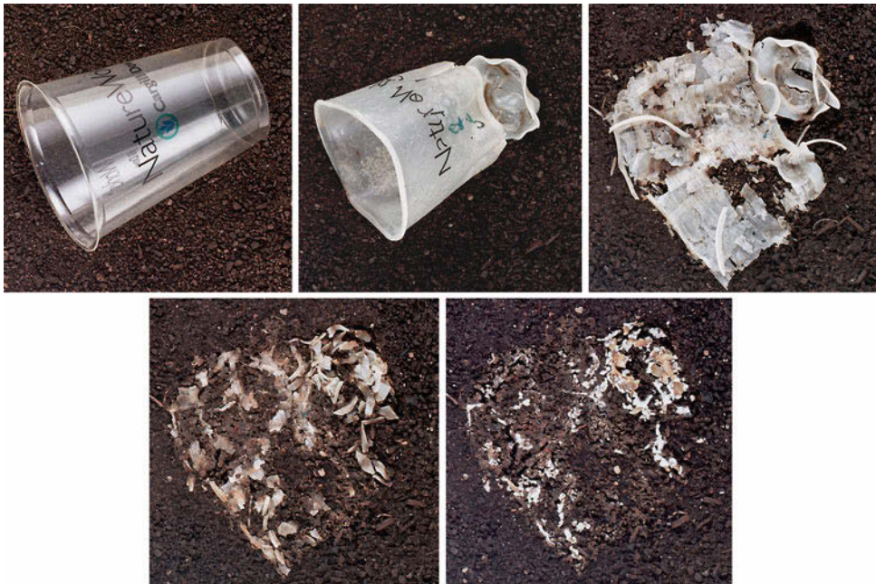
Bild 48 Biologischer Abbau von Polymilchsäure. Zeitlicher Ablauf des Zerfalls: nach einem Tag (oben links), nach 15 Tagen (oben Mitte), nach 30 Tagen (oben rechts), nach 45 Tagen (unten links) und nach 58 Tagen (unten rechts). Mit freundlicher Genehmigung von Natureworks LLC.
