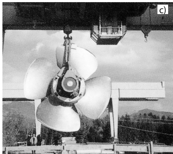
Bild 4: a) Die erste industrielle Kaplan-Turbine aus Velm, Niederösterreich, 1919; Die erste Kaplan-Großturbine und der Vergleich zu heute: b) Laufrad Lilla Edet (1925), P = 8,1 \text{ MW} , D = 5,8 \text{ m} ; c) Oberaudorf-Ebbs (1992), P = 34,5 \text{ MW} , D = 6,1 \text{ m}
