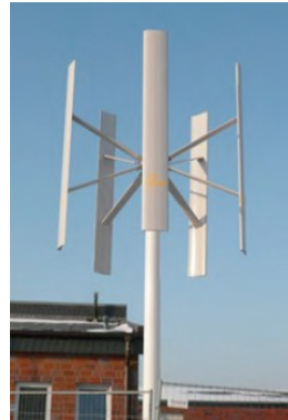
Abbildung 11: Darrieus-H Rotor [vgl. Aseptor 2013]
