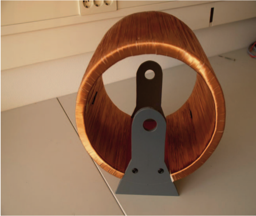
Abb. 2.3 Spule mit sichtbarer äußerer Kupferwicklung und nicht sichtbarer interner LWL-Wicklung. (Foto Winkler)
