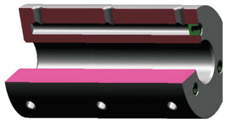
Bild 2.15: Kolbenbolzen mit Ölbohrungen und Verschlußschrauben
