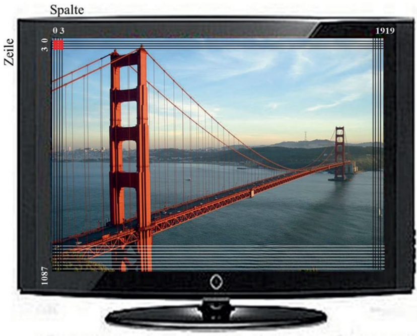
Abb. 2.3 Rasterprinzip beim HD-TV
