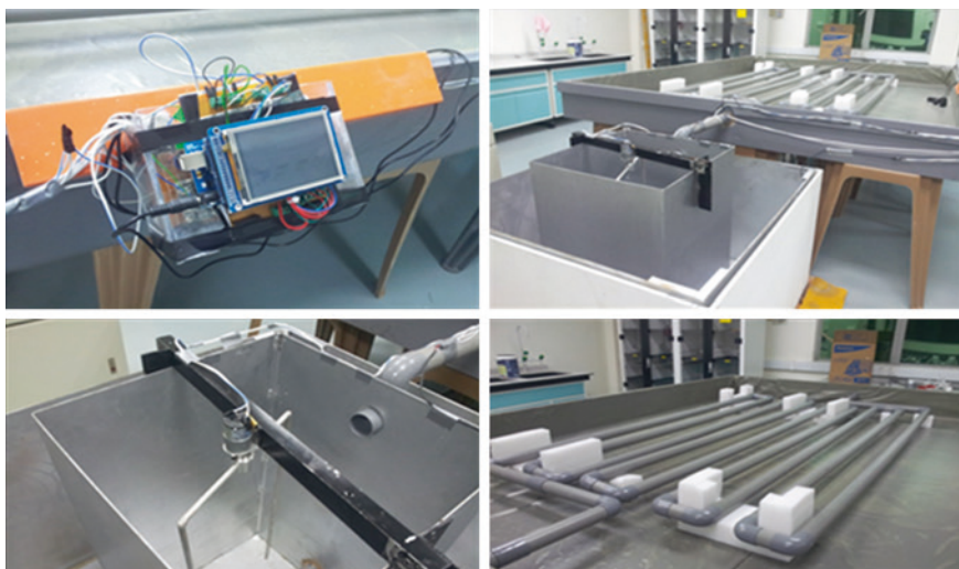
Fig. 3 Paraffin deposition apparatus
