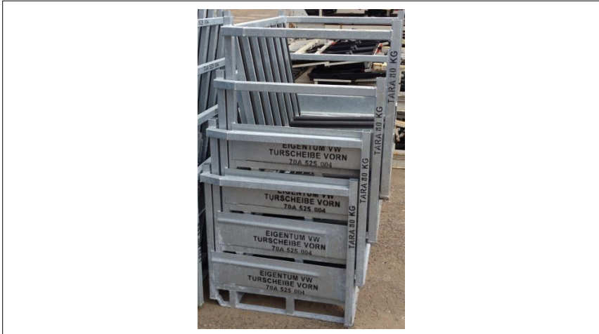
Abbildung 12: Beispiel für Volumenreduktion bei einem nestbaren Ladungsträger
