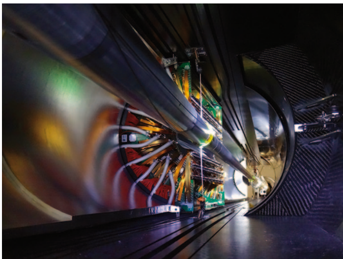
Abb. 2.4 Bild des CMS-Detektors am CERN mit dessen Hilfe, die nach einem Stoßexperiment wegfliegenden Teilchen nachgewiesen und später identifiziert werden können. (© CERN, for the benefit of the CMS Collaboration, Foto: Michael Hoch CMS-PHOTO-TRACKER-2014-001-2, http://cds.cern.ch/record/1977415 )
