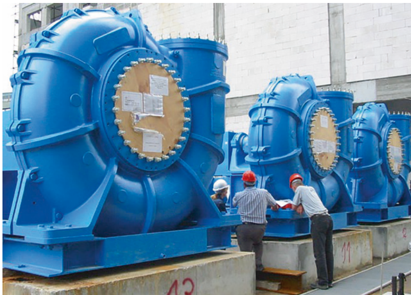
Abb. 2.6 Wäscherpumpen zur Rauchgasentschwefelung in einem Braunkohlekraftwerk. V = 13.750 \text{ m}^3/\text{h} , H = 24 \text{ m} , n = 430 \text{ U/min} (DÜCHTING)
