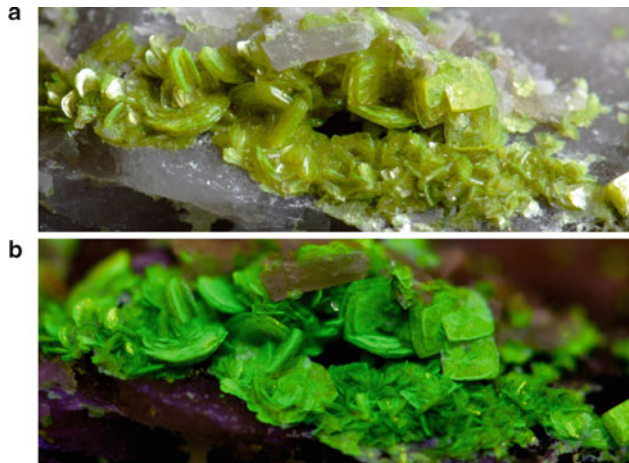
Abb. 2.1 Autunit, ein fluoreszierender Uranglimmer, \text{Ca}[\text{UO}_2(\text{PO}_4)_2 \cdot 10 \text{H}_2\text{O}] , hier ein Stück aus Portugal. a Aufnahme bei Tageslicht, b Beleuchtung mit einer „Schwarzlichtglühlampe“ und Aufnahme durch einen gelben Langpassfilter. Die Autunitkristalle leuchten aufgrund der UV-angeregten Fluoreszenz hell gelblich-grün
