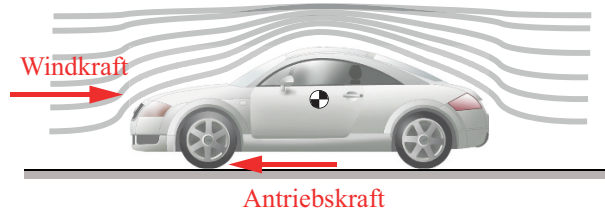
Abb. 2.1. Antriebskraft und Windkraft beim fahrenden PKW
