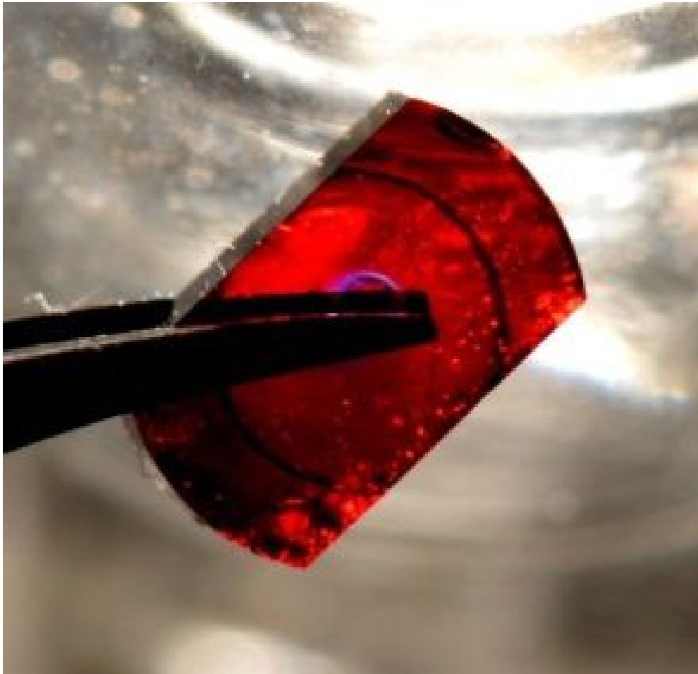
Abb. 2.1: Goldrubinglas mit der typischen roten Färbung im Durchlicht einer Schreibtischlampe. Die rote Färbung kommt durch die Absorption kurzer Wellenlängen. Rotes Licht wird nicht absorbiert, daher sieht man nur noch den roten Anteil des weißen Lichtes. Herkunft des Glases: Farbglasshütte Reichenbach GmbH; Reichenbach/OL. Mechanische Bearbeitung: Optische Lehrwerkstätten, Leica in Wetzlar.
