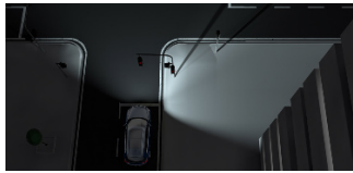
Abbildung 2.11: Statisches Abbiegelicht (Volkswagen AG, 2015b).
